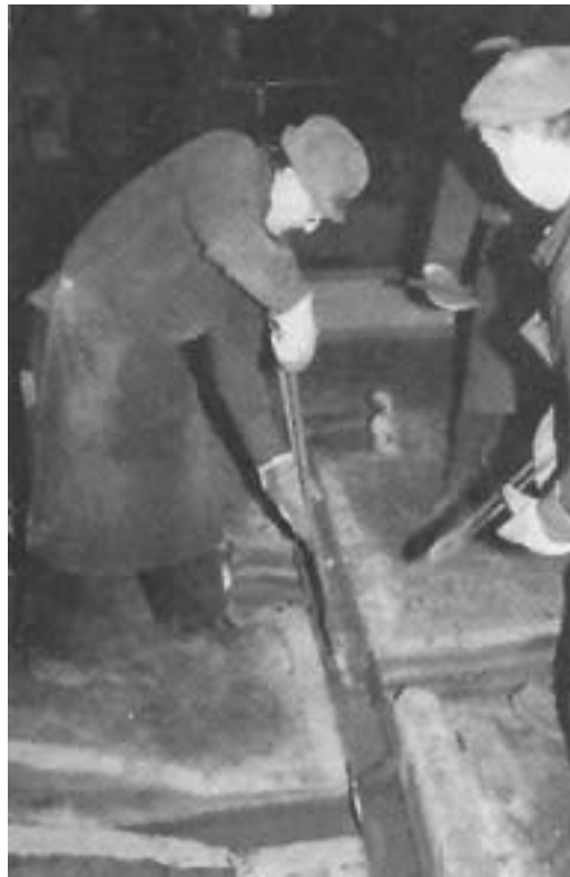
Der Glockenguss. Durch Kanäle fließt das flüssige Metall in die Formen
